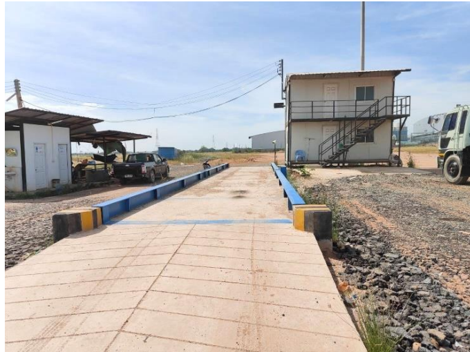
รูปที่ 20 เครื่องชั่งน้ำหนักรถก่อนและหลังเทดิน
